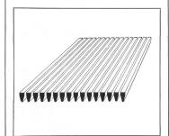
Ingtec-Entwässerungsboden in «Keilform».
