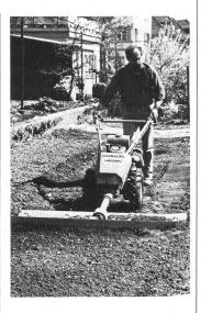
Brocken schon im ersten Arbeitsgang. Nach einem weiteren Durchgang ist der Boden fein, gleichmässig gekrümelt und planiert. Das System ist zum Patentieren angemeldet.
