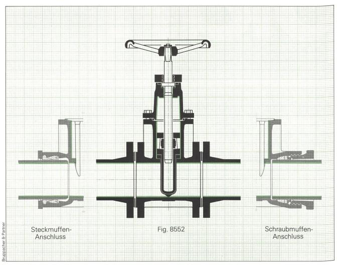
**Bereich Gasversorgung:** Von Roll Schieber mit Weichdichtung. Dieser Schieber für Gas bis 5 bar (Hochdruckstufe 1) bietet über die Anforderungen der SVGW-Zulassung hinaus: Von Roll Weichdichtung, für absolut dichten Abschluss auch nach Jahren. Penetrolbeständige Elastomer-Dichtungen aus Viton-Dichtelementen.
