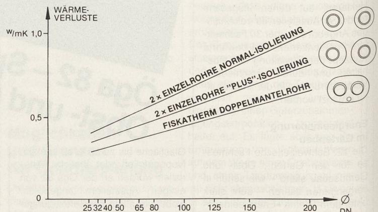
Da sich beide Mediarohre in einem ummantelten Isolierblock befinden, sind die Wärmeverluste bedeutend geringer als in jeweils zwei voneinander getrennt isolierten Rohren.
