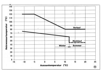
Abb. 4. Temperaturverlauf im Refuna-Hauptnetz.
