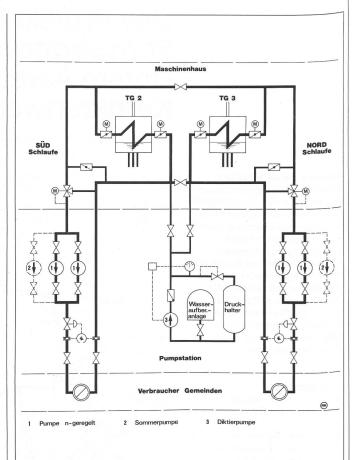
Abb. 3. Heizwasserkreislauf mit zentraler Pumpstation.
