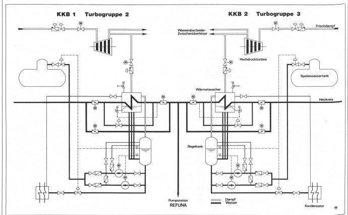
Abb. 2. Wärmeauskoppelung Turbogruppen 2 und 3.
