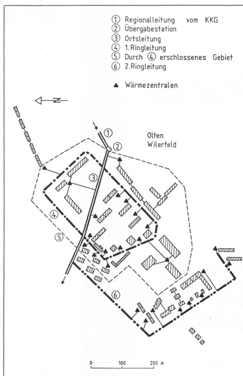
Abb. 2. Pilotanlage: Geplante Wärmezentralen.
