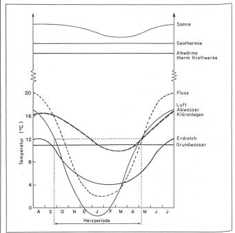
Abb. 2. Temperaturverlauf verschiedener Wärmequellen.
