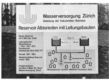
Abb. 11. Baustellen-Orientierungstafel für Reservoir Albisrieden, bezeichnet ist das hydraulische System der Druckzone Albisrieden-Leimbach.
