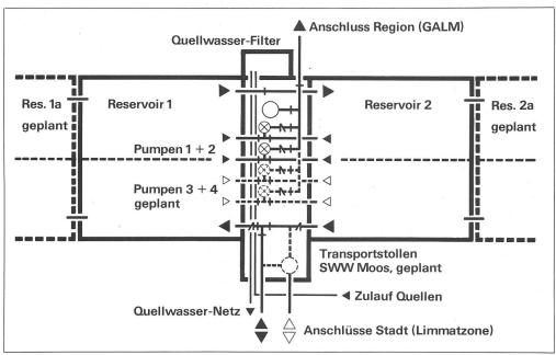
Abb. 4. Verteilanlage Lyren (1975), Reservoirinhalt 20 000 m³, Anlageausbau mit Rücksicht auf geplante Erweiterungen.
