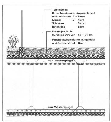
Abb. 8. Reservoir Frauental, Schnitt Reservoir/Tennisanlage.
