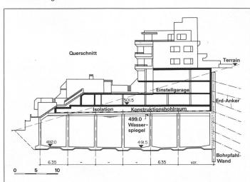
Abb. 9. Reservoir Höngg (1982), Querschnitt Reservoir/Wohnüberbauung.
