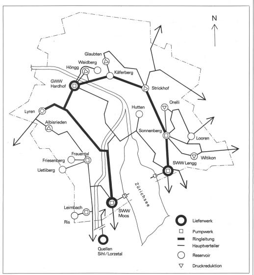
Abb. 1. Wasserversorgung Zürich, generelle Disposition der Anlagen.
