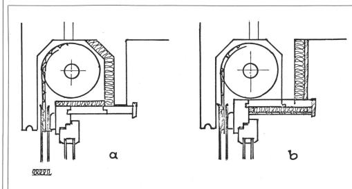
Abb. 2. Nachisolieren von Rollladenkästen: a zwischen Rolladenpanzer und Sturz; b zwischen Sturz bzw. Deckel und Rauminnenseite.
