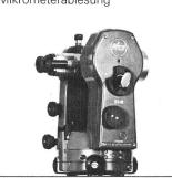
Kern E1. Elektronischer Theodolit mit Registriergerät
