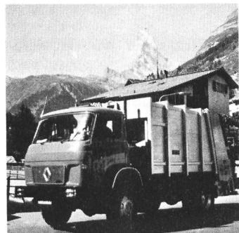
Seit kurzem in Zermatt im Einsatz: Europacker KS 4/Mini, ein überaus wendiger Kehricht- und Sperrgutwagen von Ochsner für enge örtliche Verhältnisse. Stahlgerüstaufbau mit Leichtmetallverkleidung, Inhalt 9 m³ (Chassis Renault 4x4, Breite 2150 mm). Auch ein überfüllter 800-Liter-Container kann problemlos entleert werden.
