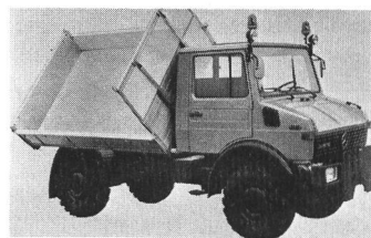
Unimog U 1000-L (125 PS) in der sogenannten Langchassis-Version mit einem Radstand von 3250 mm und einer Schweizer Kippbrücke bis 2800 mm.
