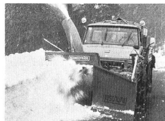
Unimog U 1000 mit Seitenschneefräse und Aufsatzstreuer.
