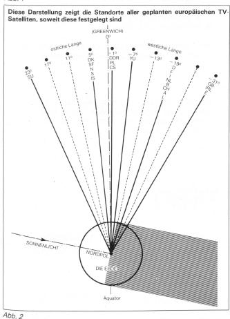
Kanalzuordnung, Orbitstationen und Polarisation nationaler Rundfunksatelliten des 12-GHz-Bereiches
