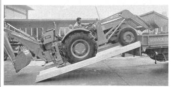
Verladeschiene Typ SP mit Baumaschinen-Bagger.
