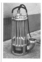
alle angesaugten Partikel ungehindert von der Ansaugöffnung zum Abflussschlauch gefördert werden. Daher sind Medien mit Korngrössen bis 60 mm Durchmesser pumpbar. Laufrad und Gehäuse sind aus sehr verschleissfestem Chromstahl gefertigt.
