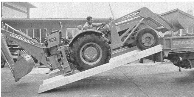
Verladeschiene Typ SP mit Baumaschinen-Bagger.
