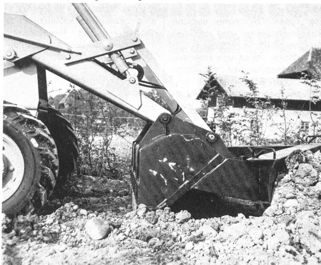
Case 580 F mit Schaufel mit Dozerblatt, 9fach verstellbar.
