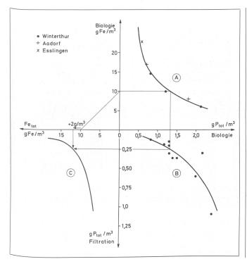
oder Mehrschichtfilter mit optimiertem Aufbau am besten geeignet. Die Flockungsfiltration bringt (z. B. bei Zugabe von 1 bis 4 mg/l Eisen im Rohwasser) eine zusätzliche erhöhte Schmutzstoffelimination durch Adsorption der gelösten Substanzen an den ausgeflockten Eisensalzen.
