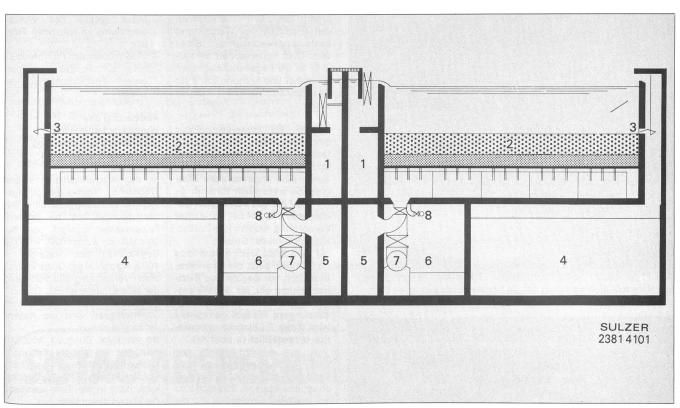
Abb. 2. Schema eines Sulzer-Doppelfilters, von denen in der Kläranlage Werdhölzli insgesamt elf Stück installiert werden. 1 Zulaufkanal; 2 Zweischichtfilter; 3 Schlammwasserklappe; 4 Schlammwasserbecken; 5 Spülwasserkanal; 6 Rohrkeller; 7 Spülwasser; 8 Spülluft. (Bild Sulzer)
