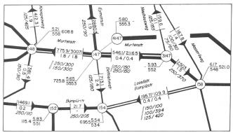
Abb. 6. Ausschnitt aus einem schematischen Rechennetzplan mit eingetragenen Berechnungsergebnissen.
