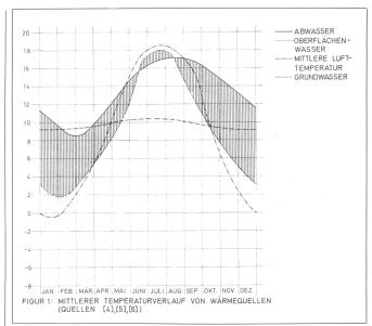
Abb. 1. Mittlerer Temperaturverlauf von Wärmequellen (Quellen [4, 5, 6]).
