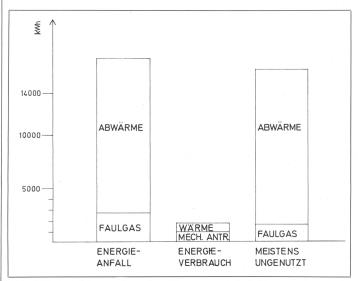
Abb. 3. Energiebilanz eines kalten Wintertages (-5°C Aussentemperatur).
