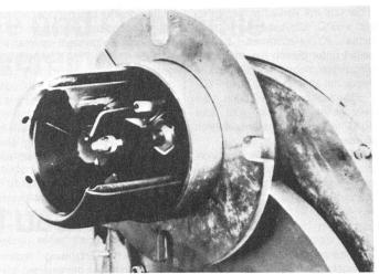
Schnittbild eines Kleinstflammkopfes mit Minidüse. Der neue Six-Madun-Brenner ist speziell für kleine Leistungen geeignet. Der Wirkungsgrad beträgt über 92 %.
