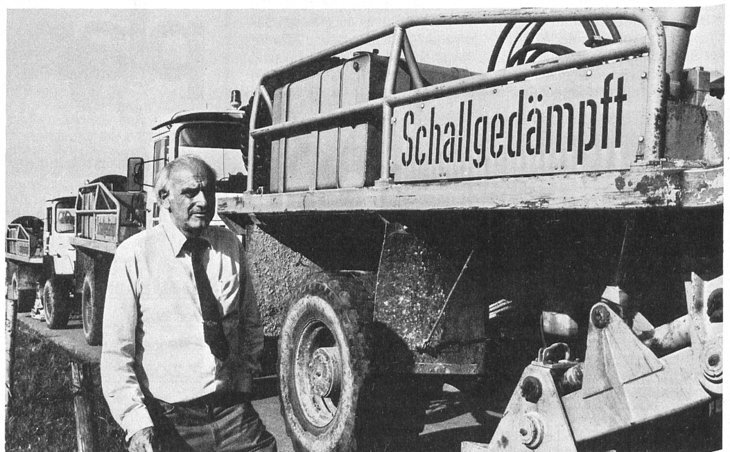
Zum Forschungsprogramm der Nagra gehören unter anderem reflexionsseismische Messungen – das «Radar» der Geologen. Die Abbildung zeigt Nagra-Präsident Dr. Rudolf Rometsch vor den Lastwagen eines Vibroseismik-Messtrupps.
