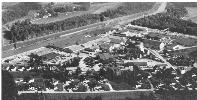
Blick auf das mit einem Aufwand von 30 Mio. Franken erneuerte und auf vollautomatische Produktion ausgebauten Werk der Zürcher Ziegeleien in Istighofen TG, in dem täglich über 80 000 Tondachziegel hergestellt werden.
