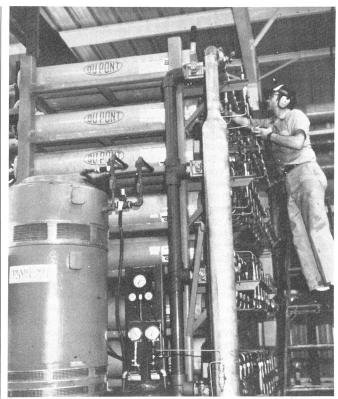
Ein Techniker prüft in der neuen Umkehrosmose-Entsalzungsanlage einen der B-10 «Permasep» Permeatoren.
