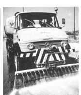
Unimog, ausgerüstet als Schwemmwagen mit Schwemmbalken und Aufbauwassertank.
