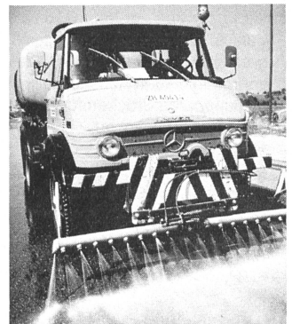
Unimog, ausgerüstet als Schwimmwagen mit Schwemmblech und Aufbauwassertank.
