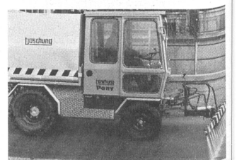
Boschung-Pony mit Schwemmanlage, Schwemmbalken beidseitig ausfahrbar.
