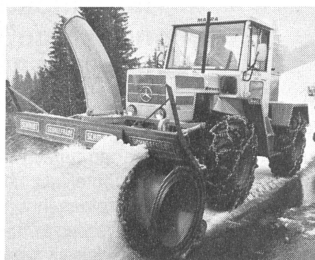
Der ebenfalls von der Daimler-Benz AG fabrizierte MB-Trac ist ein, im Gegensatz zum Unimog, langsam fahrender, aber grösstenteils aus Unimog-Aggregaten konzipierter Allradschlepper, der in sechs Varianten zwischen 65 und 150 PS lieferbar ist.
