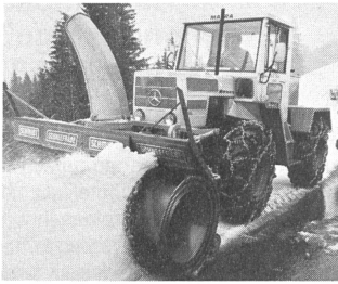
Der ebenfalls von der Daimler-Benz AG fabrizierte MB-Trac ist ein, im Gegensatz zum Unimog, langsam fahrender, aber grössenteils aus Unimog-Aggregaten konzipierter Allradschlepper, der in sechs Varianten zwischen 65 und 150 PS lieferbar ist.
