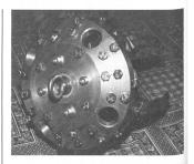
sind auswechselbar. Feste Ablagerungen im Innern des Rohrs widerstehen diesem Apparat kaum. Der ganze Apparat ist aus rostfreiem Material hergestellt und wird in einer Kiste als Set angeboten, bestehend aus: Grundkörper und drei verschiedenen Fräsern mit diversen Durchmessern:
