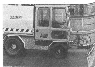
Boschung-Pony mit Schwemmanlage, Schwemmbalken beidseitig ausfahrbar.
