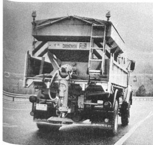
Boschung-Aufsatz-Streuauswurf auf LW beim Flüssigstreuen auf einer Autobahn.
