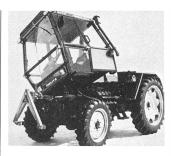
Das Allrad-Trägerfahrzeug kann mit über 70 verschiedenen Anbaugeräten eingesetzt werden. (Strassenreinigung, Winterdienst, Forstwesen. Kanalisationsreinigung, Transport und Landschaftspflege usw )
