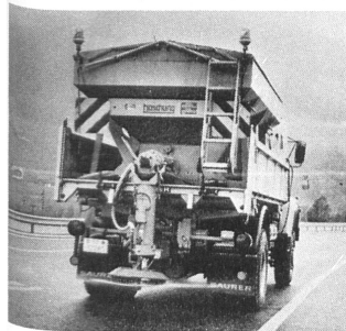
Boschung-Aufsatz-Streutautomat auf LW beim Flüssigstreuen auf einer Autobahn.
