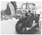
Der ebenfalls von der Daimler-Benz AG fabrizierte MB-Trac ist ein, im Gegensatz zum Unimog, langsam fahrender, aber grösstenteils aus Unimog-Aggregaten konzipierter Allradschlepper, der in sechs Varianten zwischen 65 und 150 PS lieferbar ist.
