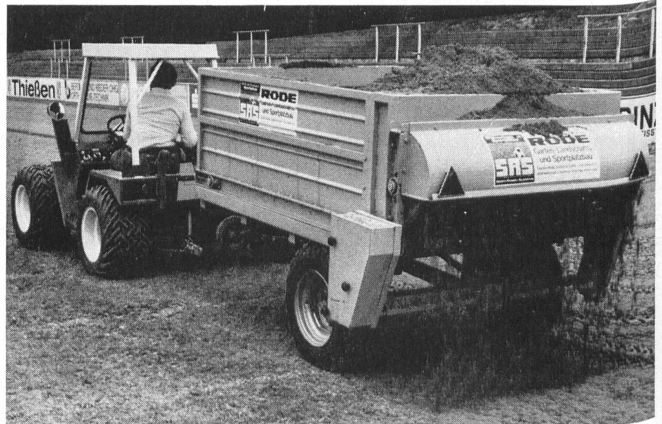
Sandstreuer auf einem Sportplatz zur Vermagerung der Rasentragsschicht.
