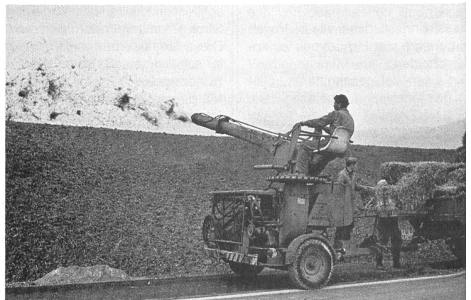
Mit diesem Gerät kann die Ansaat noch mit einer Mulchschicht überdeckt werden.
