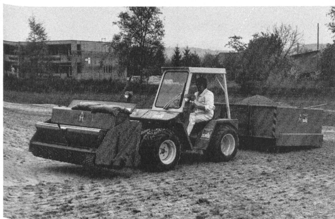
Einarbeiten der Sandschicht mit dem Intramol-Gerät.
