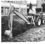
Arbeiten mit dem vollhydraulischen Heckbagger
