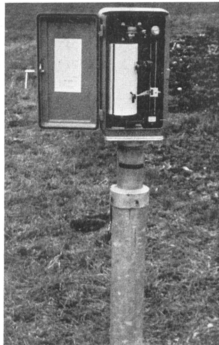
Abb. 2. Grundwasserstand- und Temperaturregistrierung im Bereich Zürcher Unterland/Glattal.
