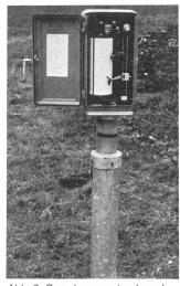
Abb. 2. Grundwasserstand- und Temperaturregistrierung im Bereich Zürcher Unterland/Glattal.
