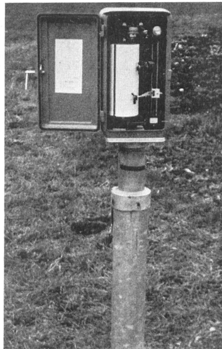
Abb. 2. Grundwasserstand- und Temperaturregistrierung im Bereich Zürcher Unterland/Glattal.
