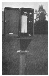
Abb. 1. Wasserstandsregistrierung im Reusstal; Kulturtechnik ETH Zürich
