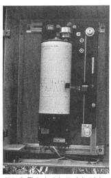
Abb. 3. Elektrisch batteriebetriebene Registrierstation für den Rhein bei Chur, mit elektrischer Druckmesssonde (siehe auch Abb. 4).
