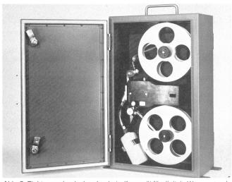
Abb. 5. Elektromechanisches Lochstreifengerät für digitale Wasserstandspeicherung.
