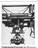
**rederkabeitromme**l als Stromzuführung zu einem Motor-Hydraulik-Baumstammgreifer, Kabelabzug vertikal
