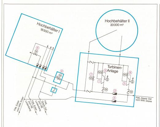
Abb. 2. Das durch die Fernwasserleitungen (FWL) von den Wasserwerken (WW) kommende Trinkwasser wird zur Stromerzeugung durch die Turbinen (Durchflussmessung durch Flowtec-Auto-Zero Serie 77) und dann zum Hoch-behälter II geleitet. Ein Teilstrom fliesst direkt durch die Nebenschlussschieber zum Hochbehälter II bzw. I.
