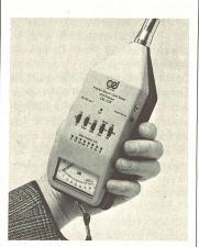
wird in drei Bereichen umgeschaltet. Als Anzeige dient ein Messinstrument mit einer linearen Skala von 40 db.
