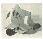
Infrarot-Wärmesichtgerät von Hughes für die zerstörungsfreie Schadenerkennung.
