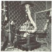
In einem Notfall wird der betreffende Motor durch ein automatisches System ausgeschaltet. Rings um den Motor angeordnete Präzisionsmikrofone nehmen die von einer Anzahl möglicher interner Quellen ausgehenden Geräusche auf, worauf die anfallenden Daten durch einen Elektronenrechner analysiert werden.
