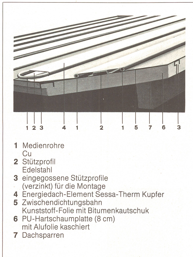
Abb. 2. Aufbau des Energiedaches.
