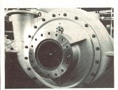
spannungsturbine kann je nach den Bedürfnissen des Anwenders eine Pumpe, einen Kompressor oder einen Generator antreiben. Die Auslegung des Austauschersystems (Verdampfer, Kondensator, Wärmeaustauscher) wird auf den konkreten Fall abgestimmt. Die zurückgewonnene Energie und der Wirkungsgrad der Anlage hängen von den speziellen Eigenschaften der betreffenden Quellen ab: Art des Mediums, Durchflussmenge und Temperatur.
