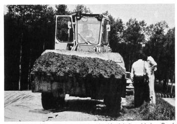
Praktische Demonstration der Flächendruckfestigkeit und hohen Durchstossfestigkeit der 2 mm starken KDB Sarnafil FP. Der Pneulader färbt ohne weiteres über die auf Kiesboden lose verlegte KDB hinweg, ohne dass diese irgendwie beschädigt wird. (Foto: Sarna Kunststoff AG, Sarnen).
