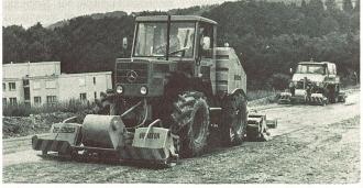
Im Vordergrund Boschung-Mehrplattenverdichter Typ MBB, ausgerüste<sup>†</sup> mit zwei Verdichtereinheiten und einem Planierschild, im Hintergrund Boschung-6-Plattenverdichter Typ BV-6.
