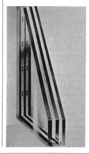
Noch vor kurzer Zeit waren die Fensterglasflächen die Schwachstellen der energiebewussten Bauweise und der Nachisolation von Altbauten. Der abgebildete Glasquerschnitt zeigt den Aufbau der in Olten und Schwarzenbach SG fabrizierten Isolar-neutralux-Isolierglaselemente. Sie bestehen aus drei glasklaren Floatglastafeln und zwei Scheibenzwischenräumen von nur 8 mm. Diese Zwischenwände sind speziell aufbereitet.
