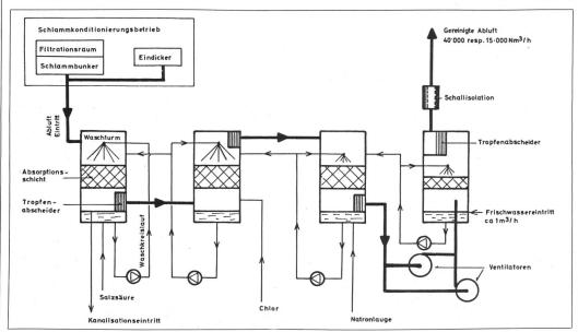
Abb. 6. Abluftreinigung der Kläranlage Werdhölzli, Zürich, Fliessschema.
