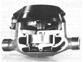
Abb. 7. Aufgeschnittener Kleinölzähler mit Ringkolbenmesskammer, für 4–150 l/h Durchsatz. (Werkfoto Aquametro AG, Basel)
