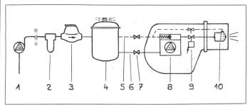
Abb. 9. Montageschema eines Ölzählers auf Brenner mit Düsenregulierung. 1 Transferpumpe, 2 Feinfilter, 3 Ölzähler, 4 Zwischenbehälter mit Entlüfter, 5 Rückführleitung, 6 Ansaugleitung, 7 Absperrhahn, 8 Zweistrangpumpe, 9 Magnetventil, 10 Regulierdüse.
