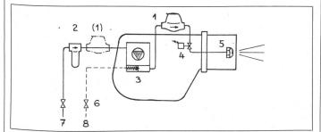
Abb. 8. Montageschema eines Ölzählers auf Druckbrenner. 1 Ölzähler, (1) wahlweise Placierung bei Brenner mit Einrohranschluss, 2 Feinfilter, 3 Zweistrang- oder Einstrangpumpe, 4 Magnetventil, 5 Düse, 6 Absperrhahn, 7 Zuführleitung, 8 Rückführleitung.
