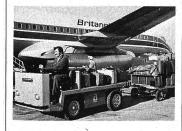
schwindigkeit stufenlos und gewährleistet ein ruckfreies und exaktes Fahren. Hydraulisch betätigte Scheibenbremsen sorgen dafür, dass der Fahrer die Situation jederzeit im Griff hat. Der hohe Fahrkomfort wird durch die Einzelradaufhängung und den hydraulisch gedämpften Schwingsitz sichergestellt.
