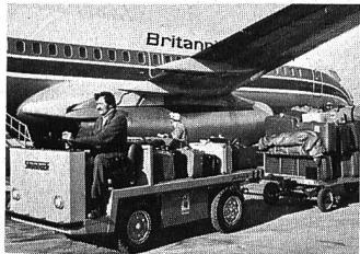
schwindigkeit stufenlos und gewährleistet ein ruckfreies und exaktes Fahren. Hydraulisch betätigtes Scheibenbremsen sorgen dafür, dass der Fahrer die Situation jederzeit im Griff hat. Der hohe Fahrkomfort wird durch die Einzelradaufhängung und den hydraulisch gedämpften Schwingsitz sichergestellt.
