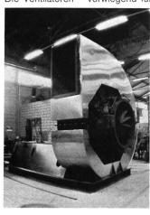
Industrieanlagen, so auch für Müllverbrennung und Rauchgasreinigung, Wasseraufbereitung, Tankreinigung usw. – werden für jeden Bedarfsfall optimal ausgelegt und einzeln gefertigt, auch für extreme Anforderungen hinsichtlich Förderdruck, Temperatur, Korrosionsfestigkeit usw. Ausser aus Baustahl, hitzebeständigen und rostfreien Stählen, Kupfer und anderem werden die Radial- und Axialventilatoren auch aus Kunststoffen oder mit Gummi- bzw. Kunststoffbeschichtung geliefert.
