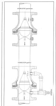
schliesst an der Wand des Gehäuses an. Dadurch ist eine ungehinderte Durchströmung möglich. Sobald der Druck wegfällt, schliesst die Membrane durch Eigenspanung und bildet am Strömungskörper durch ihre Elastizität einerseits eine Dämpfung des Druckstosses, anderseits einen dichten Abschluss
