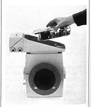
Der Kompakt-IDM Copa ist in den Nennweiten DN 15 bis DN 250 lieferbar. Die Auskleidung kann zwischen den bekannten Werkstoffen wie Hartgummi, PTFE usw. ausgewählt werden. Als Ausgangssignale stehen 0/4 bis 20 mA und ein normierbarer Impulsausgang zur Verfügung. An dem normierbaren Impulsausgang kann ein elektronischer oder elektromechanischer Impulszähler betrieben direkt werden.
