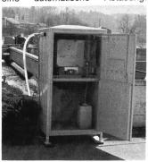
Durch die Luftumwälzung können die Proben echt auf +3°C abgekühlt werden, was bei einem normalen Kühlschrank kaum möglich ist.
