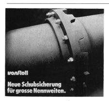
Die neue Von-Roll-Schubsicherung Fig. 2505 S. Für Steckmuffenrohre (K=10) in den Nennweiten DN 400, 500 und 600. Nenndruck bis 16 bar. Allseitige Abwinkelungen bis 3°.
