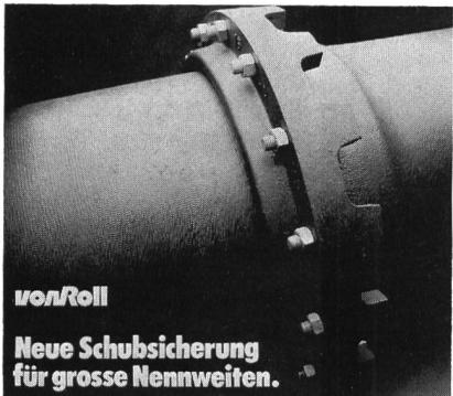
Die neue Von-Roll-Schubsicherung Fig. 2505 S. Für Steckmuffenrohre (K = 10) in den Nennweiten DN 400, 500 und 600. Nenndruck bis 16 bar. Allseitige Abwinkelungen bis 3°.
