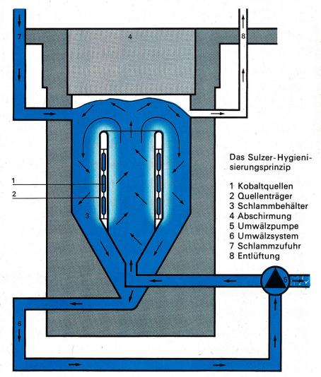
Das Sulzer-Hygienisierungsverfahren mit Gammastrahlen ist sehr einfach. Die Anlagen sind absolut strahlensicher konstruiert und erfordern kein zusätzliches Bedienungspersonal. Die Aktivierung des Schlamms durch Bestrahlung ist aus physikalischen Gründen ausgeschlossen.
