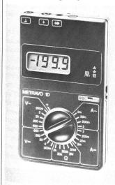
Vielfachmessgerät mit digitaler Anzeige Metravo 1D.
