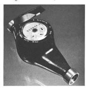
Wasser in Berührung kommt, ist der zwischen zwei Saphirkugeln gelagerte Messflügel. Seine Umdrehungen werden durch eine erprobte Magnetkupplung auf das Zählwerk übertragen.
