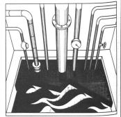
Die Feuerabdichtung der Kabelführung mittels Zschokke-Isotherm-Mörtel verhindert das Ausbreiten von Flammen und Rauch und schützt somit die technischen Anlagen.
