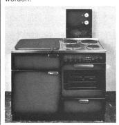
Der Holzkochherd: Kochen auf der Gussplatte, heizen - einerseits die Küche direkt, anderseits werden die Rauchgase genutzt, indem sie durch einen Kachelofen (Sitzbank) im Wohnzimmer geleitet werden. aufbereiten: Warmwasser Der Feuerraum wird mit einem Heizelement ausgelegt und heizt einen (meist elektrisch kombinierten) Boiler auf.
