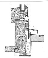
Schnitt A-A: unterer Anschluss mit Fensterbank
