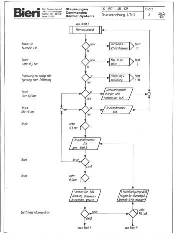
Abb. 4. Ausschnitt aus dem Flussdiagramm der Stromläufe.
