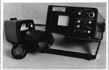
Abb. 5. Die Messausrüstung, bestehend aus Aufnahmeeinheit und Monitor.
