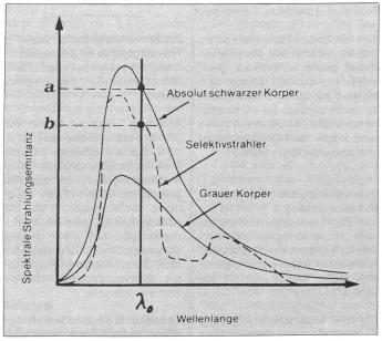
Abb. 3. Darstellung der Strahlungsverteilung des «schwarzen» Körpers und eines realen Strahlers. Die Strahlung des realen Körpers liegt um den Emissionsfaktor unter derjenigen des «schwarzen» Körpers.
