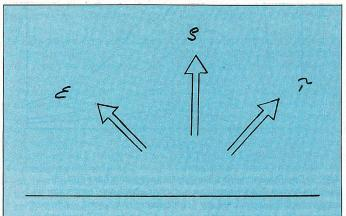
Abb. 4. Die von einer Oberfläche abgestrahlte Energie besteht aus Reflektion, Absorption, Transmission.
