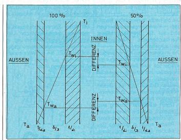
Abb. 7. Wärmedämmung – Gegenüberstellung
