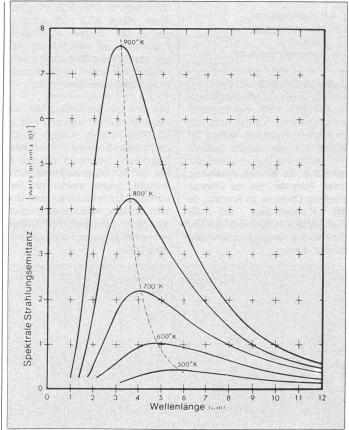
Abb. 2. Das Planksche Strahlungsgesetz in grafischer Form. Es beschreibt den Zusammenhang zwischen absoluter Temperatur und spektraler Leistungsdichte der Temperaturstrahlung des «schwarzen» Körpers. Die Temperatur ist in °Kelvin = °Celsius +273 angegeben.
