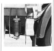
und Leitungen fallen grössere Mengen von Kondensat an, die, zusammen mit den übrigen Verunreinigungen, an der empfindlichen Druckluftanlage der Fahrzeuge zu vielerlei Störungen führen (Korrosion, Verkleben von Ventilen, im Winter Vereisung).
