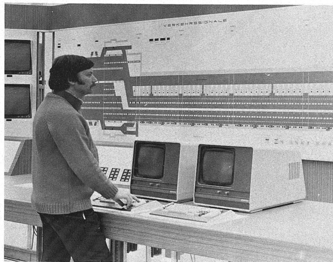
Sensoren und Kameras im Innern liefern alle erdenklichen Informationen über das Verkehrsgeschehen an zwei Siemens-Verkehrsrechner. Die Computer ordnen und verknüpfen die zahlreichen Daten zu einem dichten Gesamtbild, das den Kontrollbeamten in Göschenen und Airolo rasches Reagieren ermöglicht.
