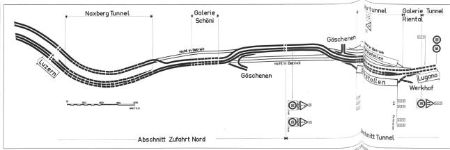
Zufahrt Nord. Spurführung 1980–1982, Tunnelsignalisation Portalbereich und Abschnittsgrenze Tunnel/Zufahrt Nord für Bedienung der Verkehrsste<sup>UC</sup>
