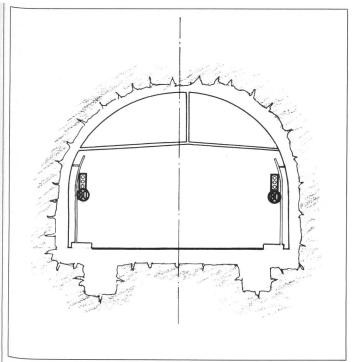
Anordnung der Signale im Tunnelquerschnitt.
