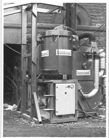
Staubabscheider DC Ventilation mobil, 37 kW, als Entlüftungsaggregat. Dieses Aggregat besteht aus zwei parallelgeschalteten Zyklonen vom gleichen Typ wie beim Hochdruckaggregat. Als Saugaggregat dienen zwei zweistufige Ventilatoren zu je 18,5 kW. Die gesamte Luftfördermenge beträgt ca. 10 000 m³/Stunde.
