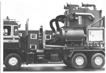
Dieses Bild zeigt das aufgeladene Saugaggregat Typ DC Ventilation mobil mit den beiden Zweistufenventilationsaggregaten und zwei Filterblöcken.
