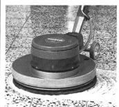
Bodenreinigungsmaschine Wetrok-Servomat 415E beim Fegen mit Wetrok-Autiwax.
