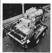
Mobilgerät 1502, Antrieb durch Deutz-Dieselmotor Typ BF6 L913.
