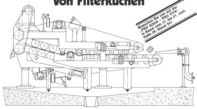
Durch Nachpressung auf der ANDRITZ-CPF-Entwässerungsmaschine werden bis zu 75% der ursprünglich im Filterkuchen enthaltenen Wassermenge entfernt. Daher wird in der nachfolgenden Trocknung ein Großteil der thermischen Energie eingespart. Das Anwendungsgebiet der ANDRITZ-CPF-Entwässerungsmaschine in der Prozeßtechnik umfaßt sämtliche kompressible Filterkuchen organischer und anorganischer Substanzen.
