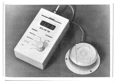
teriebetriebenen Integrator. Die Messresultate werden digital angezeigt (4stellige LCD-Anzeige). Auch bei ausgeschaltetem Gerät bleiben die gemessenen Energiewerte gespeichert und sind gegen Fehlbedienung geschützt. Das Solar 118 ist ein Messgerät mit einem äusserst günstigen Preis-Leistungs-Verhältnis.
