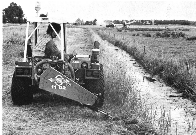
Busatis-Doppelmessermähbalken am Heckdreipunkt für Arbeiten in unzugänglichem Gelände.
