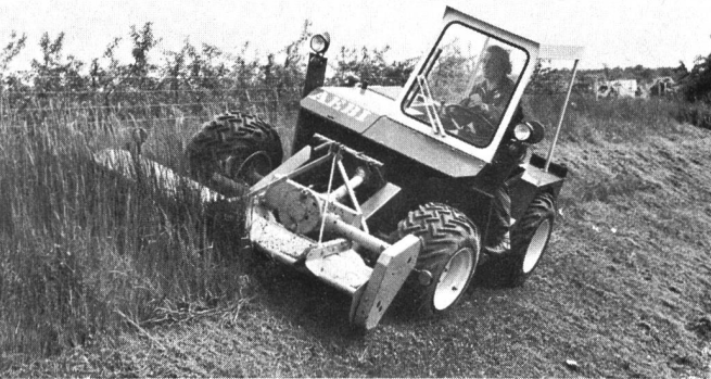
Terratrak mit Schlegelmäher an Autobahnböschung.
