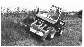
Terratrac mit Schlegelmäher an Autobahnböschung.
